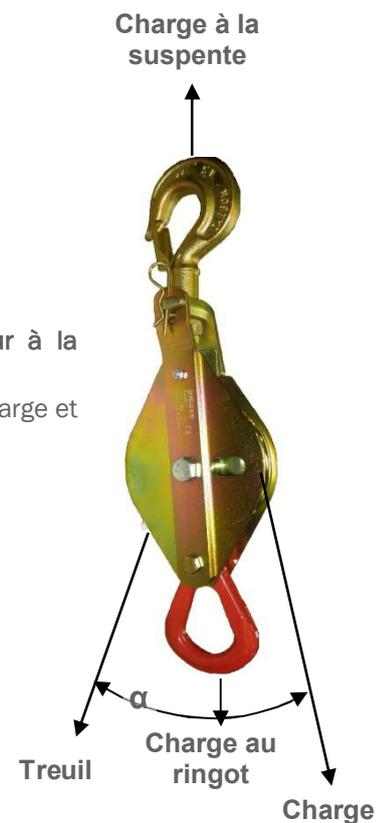
**Remarque importante :** dans le cas de l'utilisation de la poulie pour un mouflage 3 brins, ajouter à la charge à la suspente décrite ci-dessus la charge au ringot. La valeur totale de la charge ainsi déterminée doit toujours être inférieure à la Charge Maximale d'Utilisation (CMU) de la poulie.
